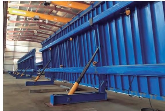
Venezuela: instalación completa para la producción de 3.000 viviendas prefabricadas por año, utilizando mesas basculantes de 15.5 x 3 metros.
