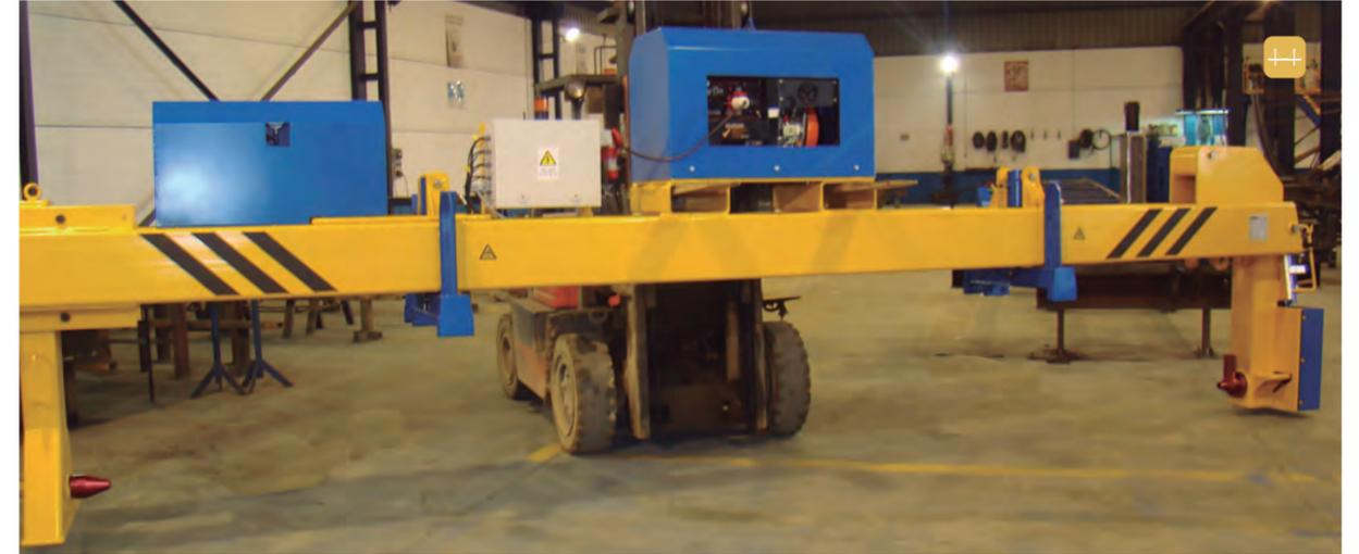
Volteador para la extracción y volteo de barrera New Jersey.
