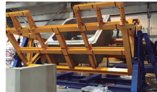
Este volteador para marcos y tuberías cuenta con marcado CE y está diseñado para voltear las piezas 90° a su posición final.
