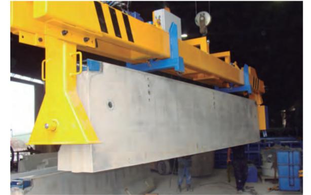
Detalle de volteador con elemento prefabricado.
