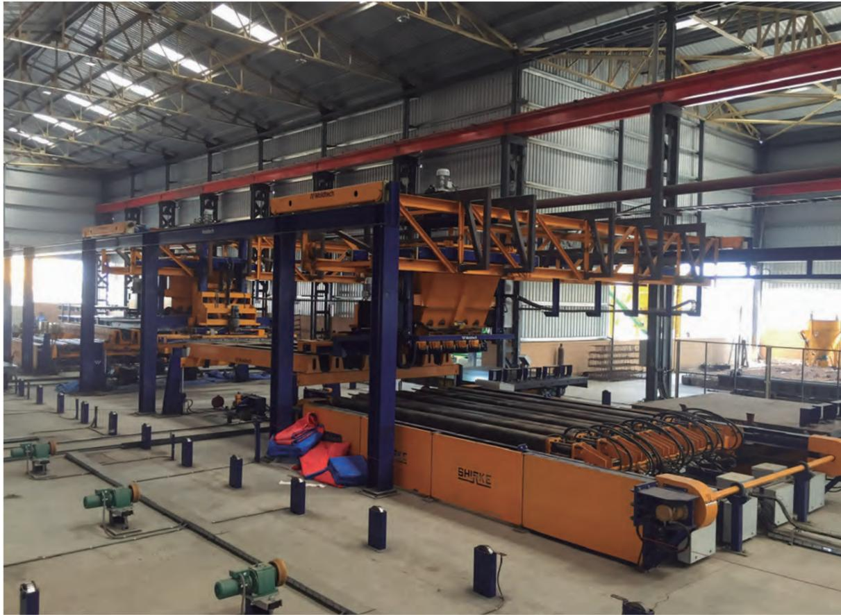
MOLDTECH diseña y fabrica sistemas de carrusel, para diferentes tipos de elementos prefabricados que requieren alta productividad, como canaletas de cables, arquetas, elementos decorativos, etc. El carrusel mueve los moldes por las diferentes estaciones del proceso, como llenado, curado asistido por vapor; desmoldeo y limpieza. Este sistema permite fabricar elevadas cantidades de elementos de forma continua.
