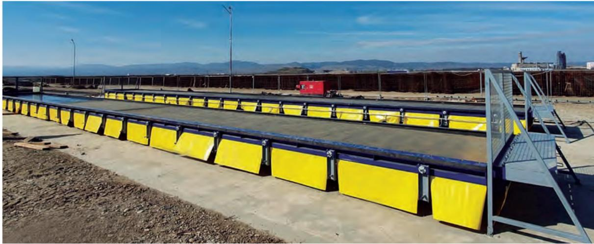
Las mesas fijas están especialmente diseñadas y construidas para fabricar losas y prelosas de hormigón.
