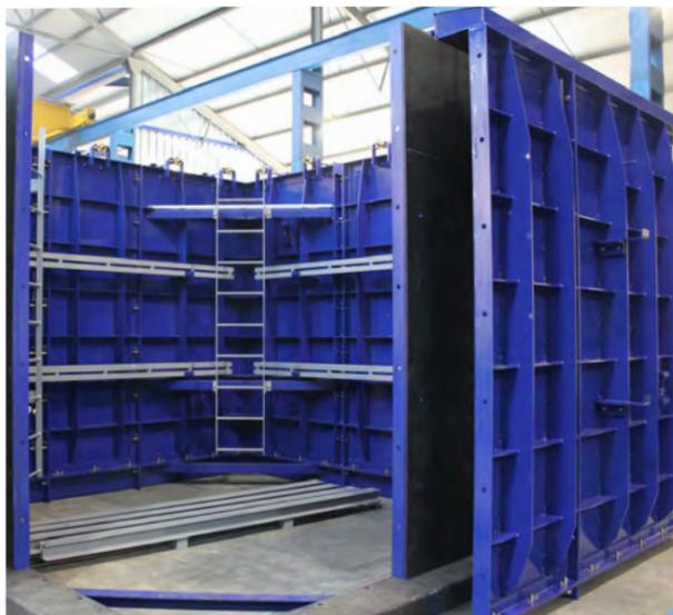
Sistema manual para fabricar marcos de hormigón fluido "wet cast".
