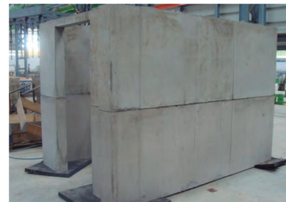
Sistema modular especialmente diseñado para fabricar piezas de hormigón semi seco para construir huecos de ascensor.
