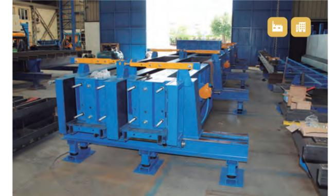
Molde de columnas doble hidráulico con tapones de extremo.
