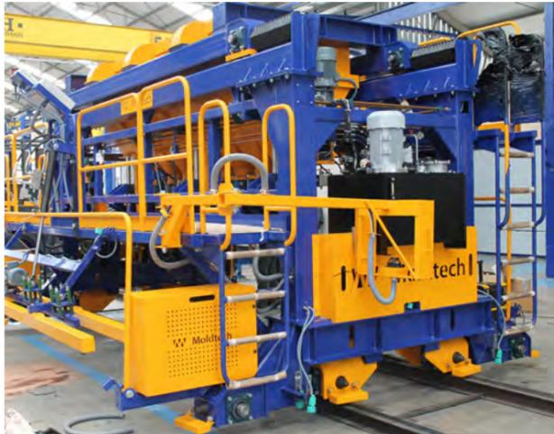
Máquina automática para distribuir el hormigón de forma uniforme, sobre mesas basculantes y otros equipos, en un proceso rápido y eficaz, con elevado control de calidad.
