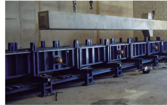
Molde de columnas hidráulico.
