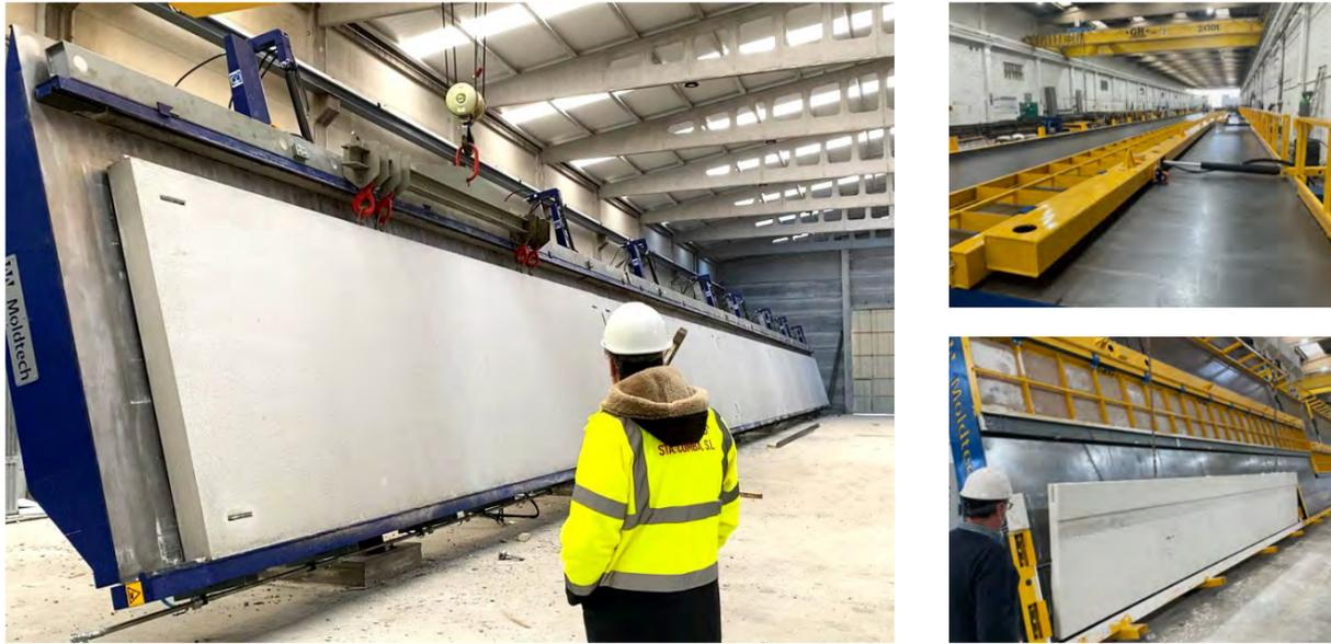
Las mesas basculantes de Moldtech están diseñadas para producir paneles prefabricados de hormigón en varios espesores, para construcciones residenciales, comerciales e industriales. Su mecanismo de basculación permite retirar los paneles fácilmente en la posición vertical con menos tiempo de endurecimiento del hormigón.
