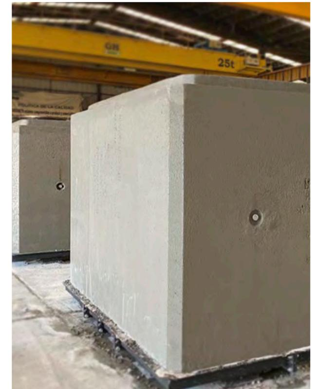
Piezas de canalón después del desmolde.
