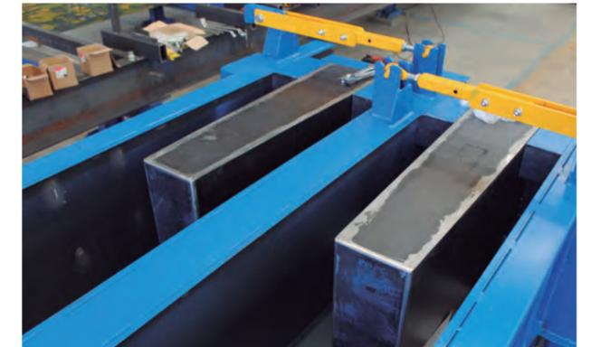
Tapa de extremo preparado para conexión con viga.
