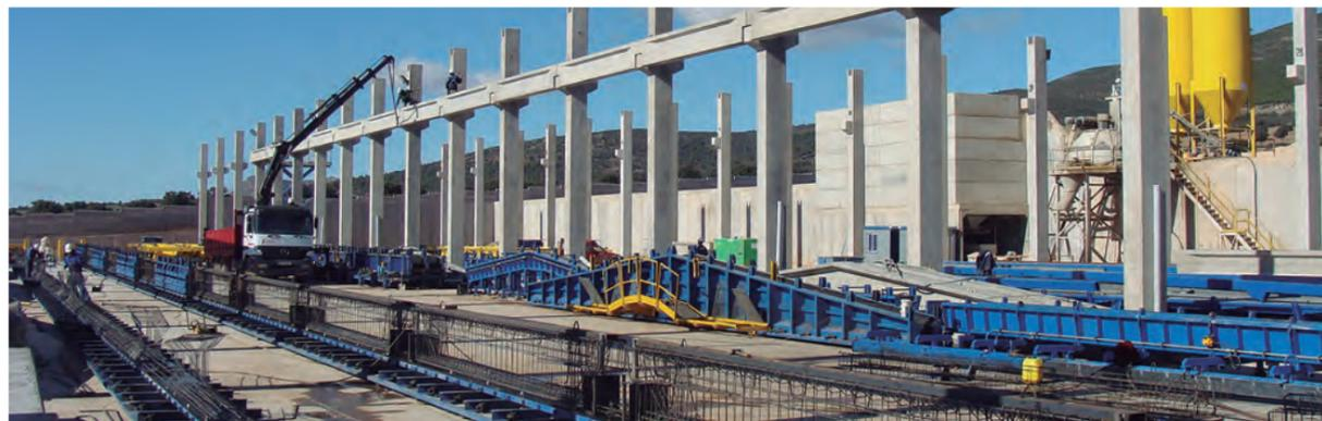
Laterales para placas y vigas tipo 'Omega'
