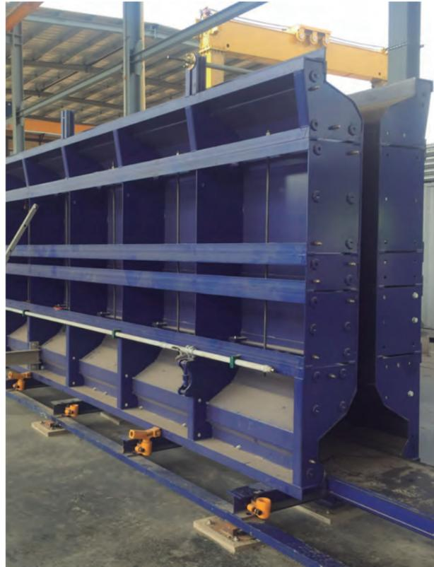
Moldes laterales para vigas de puente.
