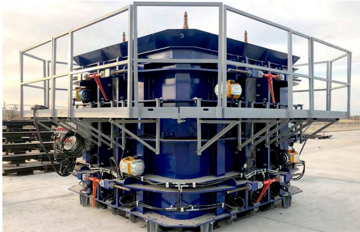
Sistema de marcos de alto rendimiento para fabricación de marcos en hormigón semiseco.
