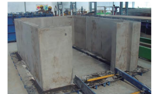
Pieza del hueco del ascensor terminada.
