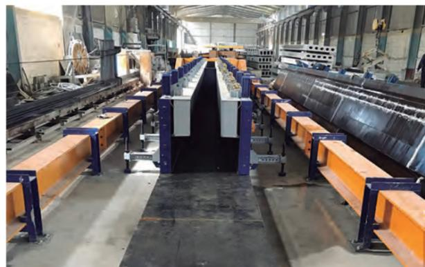
Pista universal y laterales con estructura autoportante de acero.
