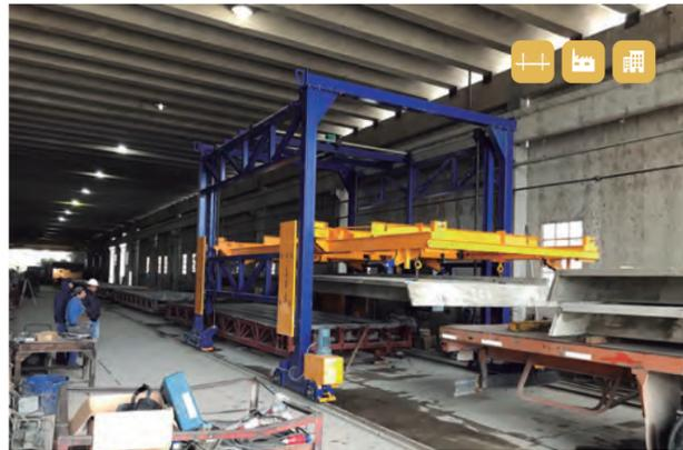
Equipo automático para elevación de placas.
