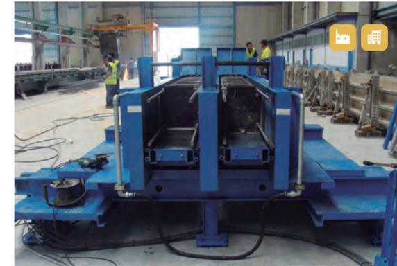
Molde de columnas doble preparado con armadura.
