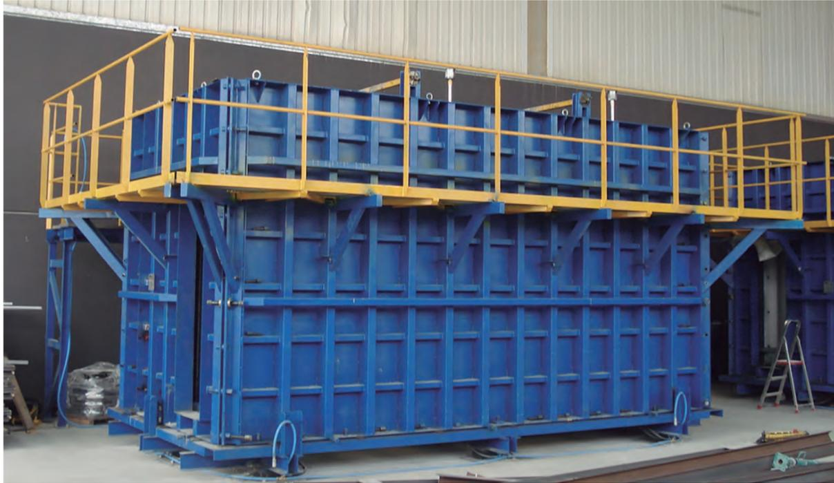
Este tipo de maquinaria permite fabricar piezas de cuatro paredes, además de techo o suelo, con lo que se evitan las uniones de varios elementos para conseguir la pieza final. Tienen distintas utilidades, tales como: centros de transformación eléctrica, módulos para viviendas, celdas penitenciarias y módulos para contenedores soterrados, baños prefabricados, etc.
