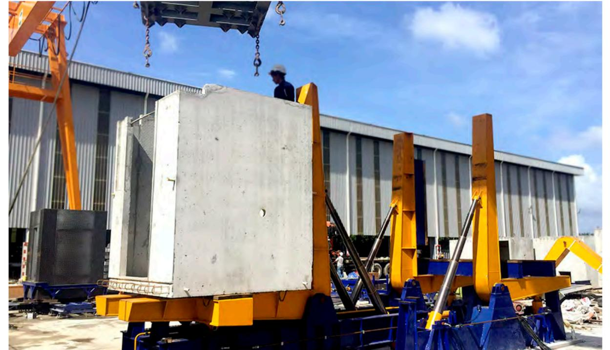
Esta máquina está diseñada para el volteo de elementos tridimensionales, con movimientos automatizados en un total de 180°.
