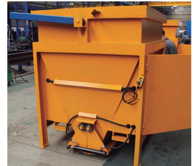
Equipo diseñado para trasladar el hormigón y llenar los moldes, con una capacidad de 2 m<sup>3</sup> y 3 m<sup>3</sup>. Cuenta con alimentación eléctrica autónoma o con conexión a red, apertura hidráulica de la compuerta y mando por cable.
