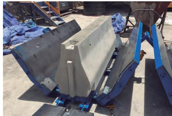
Detalle de pieza de hormigón terminada.
