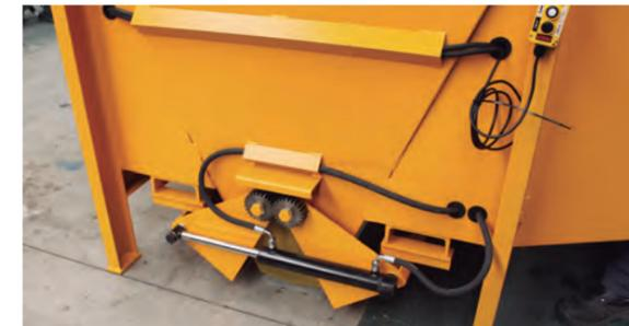
Detalle del sistema de apertura hidráulico.
