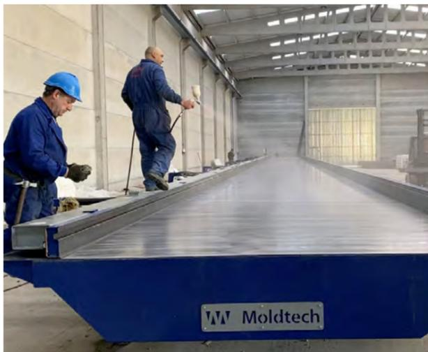
Las mesas basculantes fabrican paneles prefabricados de hormigón destinados a cerramiento tanto de naves industriales como de edificios públicos y residenciales.
