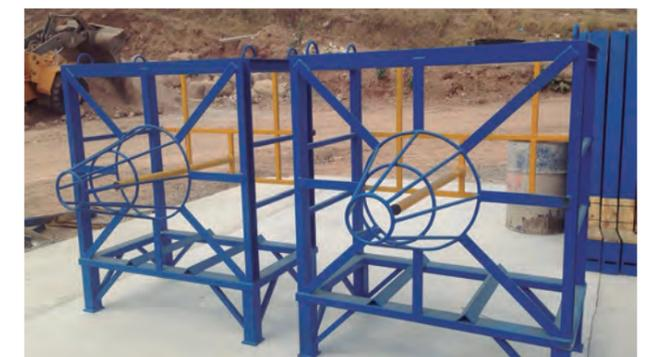
Caja dispensadora de cables para tensado.
