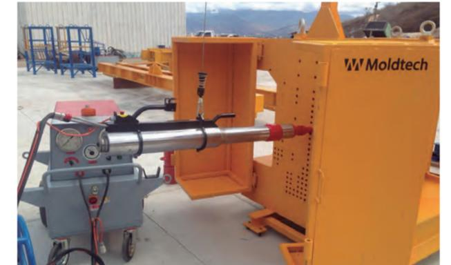
Cabezal activo de pretensado.
