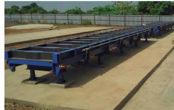
Mesa para la producción de cubiertas de canales de drenaje.
