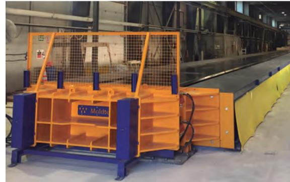
Molde autoportante de placas TT para techos y pre-losas de edificios industriales, comerciales, hospitales y garajes de parking.
