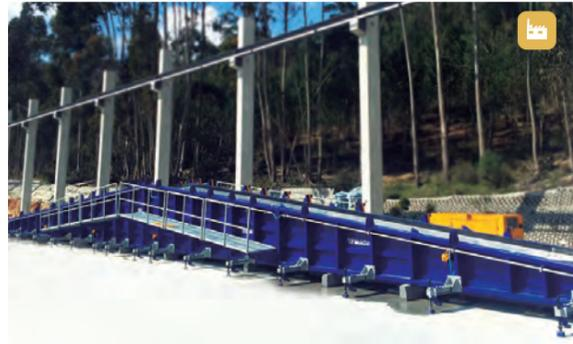
Molde lateral de viga Delta en la pista universal.
