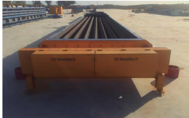
Molde auto resistente para la producción de viguetas pretesadas.
