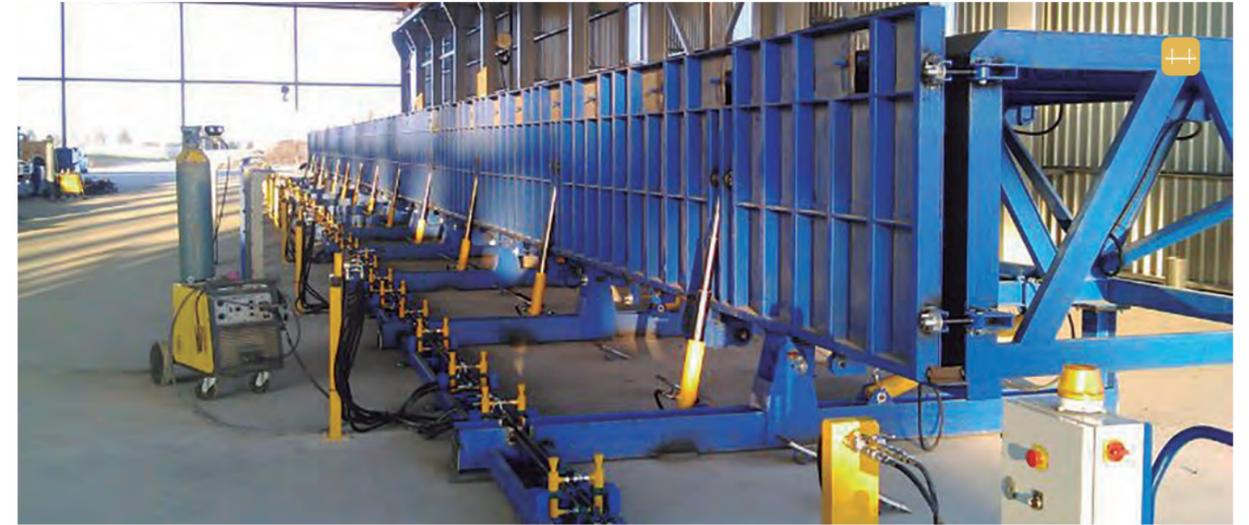
Molde para fabricar piezas en forma de «L» para muro de contención en proyectos de carreteras. Su funcionamiento es similar al de una mesa basculante. El sistema de desmoldeo es fácil, para extraer las piezas con la ayuda de una carretilla elevadora.
