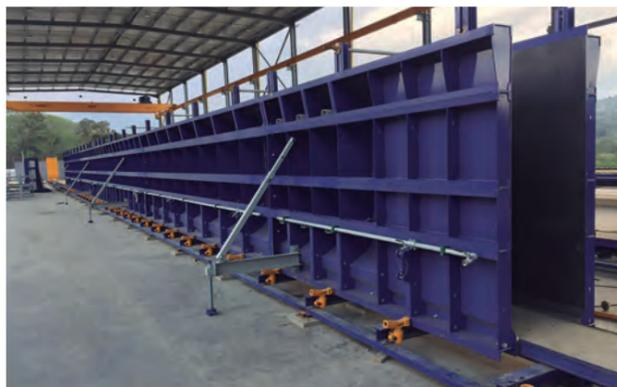
Molde lateral de viga 'I' en la pista universal.
